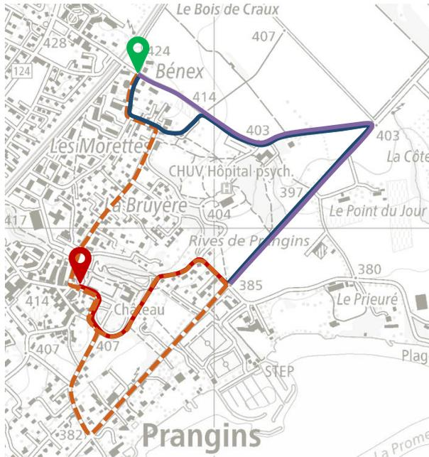
**Tracé bleu** : non retenu en raison d'un gabarit insuffisant au niveau du passage des Morettes (largeur disponible : 4,0m).
