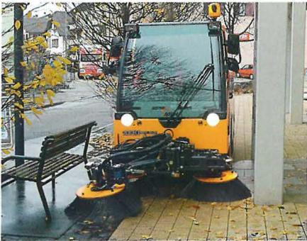
Avec une largeur du véhicule de 129 cm, le nettoyage de passages étroits ne pose pas de problème.
