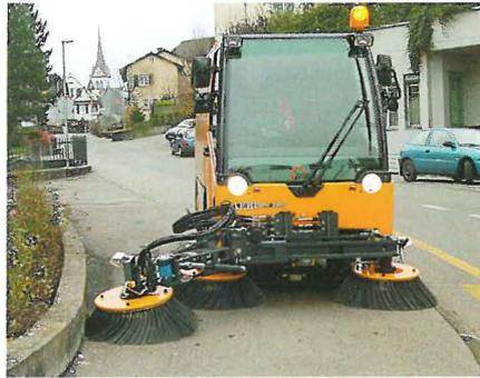
Largeur de balayage maximale avec balai frontal: jusqu'à 260 cm.
