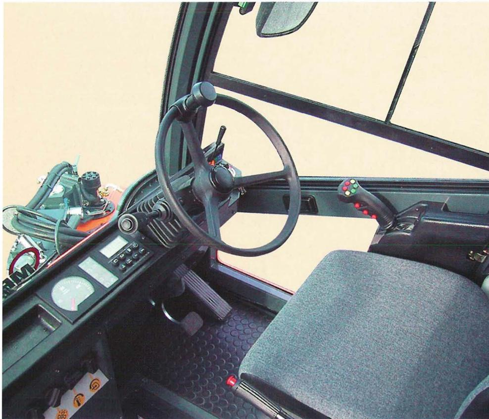
La commande par menu et le levier multifonctions pour la commande des principales opérations rendent le travail très agréable et sûr. La fenêtre aménagée dans le sol de la cabine, par laquelle la buse d'aspiration peut être surveillée directement, est particulièrement appréciée. Le chauffage puissant et la ventilation performante ainsi qu'une climatisation exempte de HCFC proposée en option permettent de travailler dans un environnement confortable.
