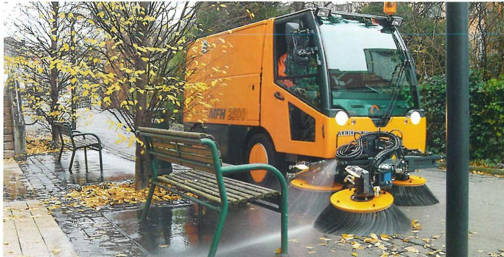
La rampe de lavage se monte directement sur le support du balai frontal. Avec 20 ou 50 bars et les 2200 litres de capacité de son réservoir d'eau, la MFH 2500 est un vrai véhicule de lavage, sur une largeur atteignant 260 cm.
