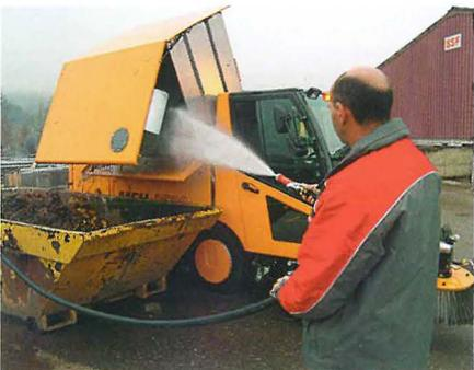
Vidage dans des bennes jusqu'à 135 cm de hauteur et lavage H.P. jusqu'à 200 bars avec la pompe intégrée.
