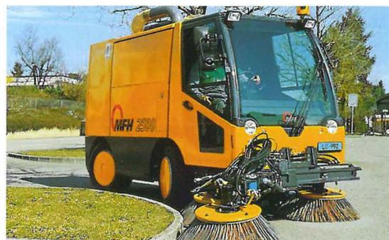
La possibilité d'adjoindre la direction sur les 4 roues rend l'Aebi MFH 2500 encore plus maniable.
