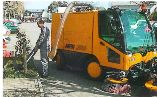
Nettoyage des bordures et vidage des puits et boîtes à ordures avec le tuyau d'aspiration.
