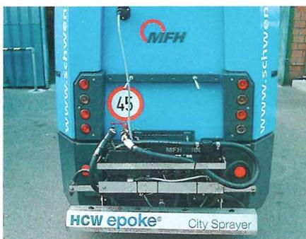
Lutte contre le verglas avec une solution saline dosée en fonction du chemin. Largeur de travail jusqu'à 300 cm, capacité du réservoir jusqu'à 2200 l.
