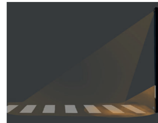
hors détection d'utilisateur: projecteur sommital (éclairage vert.) - 30% Système bas (éclairage horiz.) - 100%
