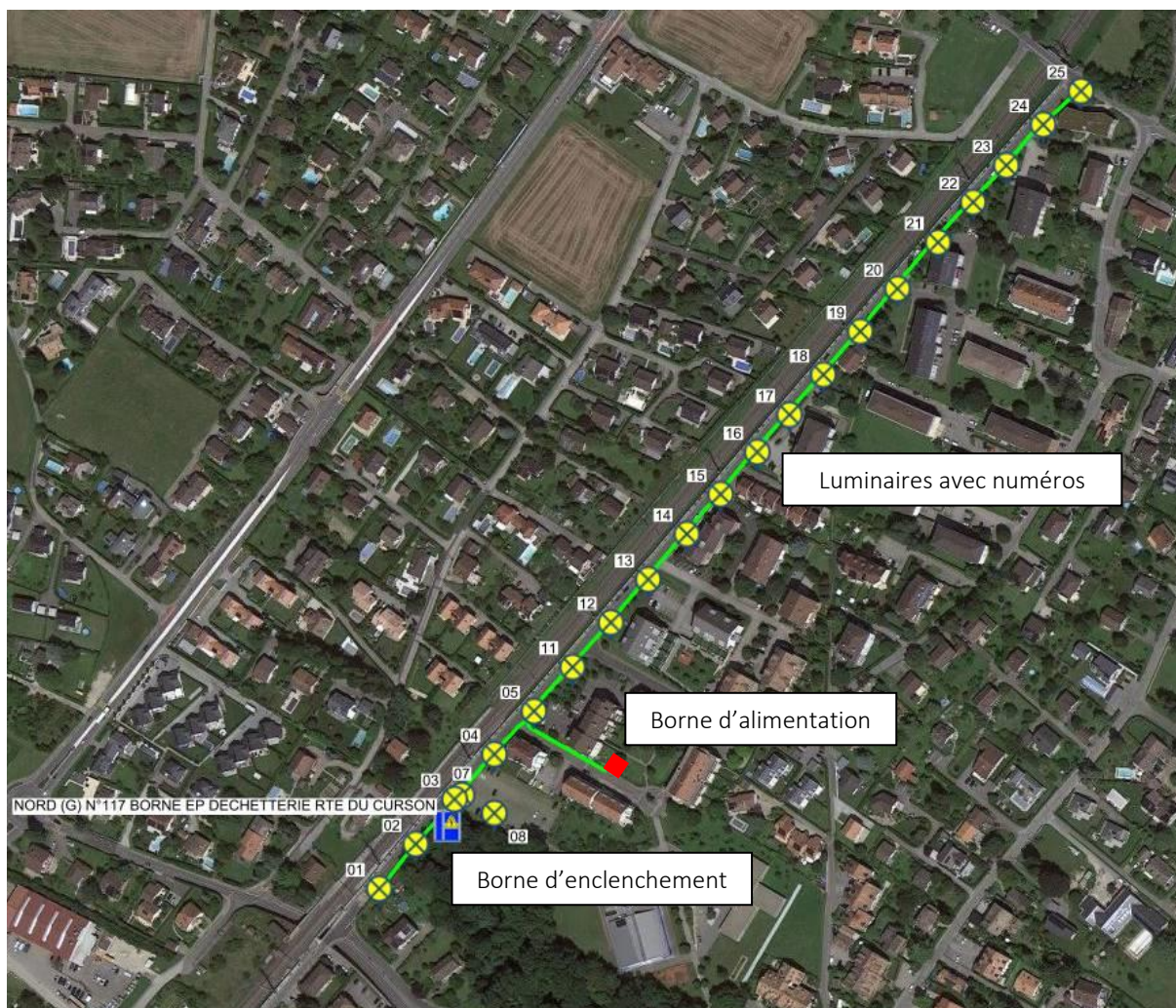
Fig. 7 - Les luminaires concernés sont reliés en vert à l'exception des deux mâts du parking des Morettes
