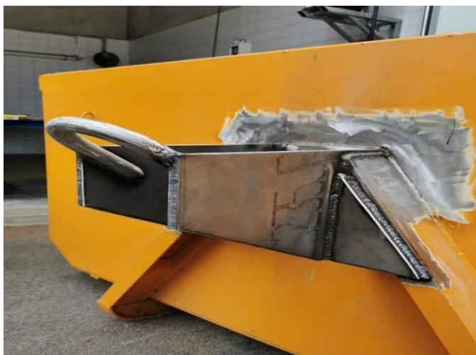
*Des modifications des crochets d'attache de plusieurs bennes ont été réalisées pour être utilisées avec le nouveau véhicule.*
